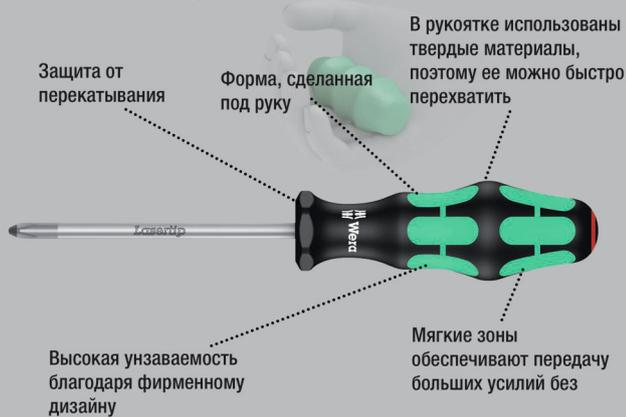
Высококачественная отвёртка Kraftform Plus для электриков. Многокомпонентная ручка Kraftform Plus для комфортной работы без появления на руках мозолей и волдырей. Твердые зоны ручки для высокой скорости работы, в то время как мягкие зоны ручки обеспечивают передачу больших моментов силы. Наконечники Lasertip отверток Wera обработаны лазером до получения микроскопической шероховатости. Такая поверхность буквально „вгрызается“ в головку винта. О непроизвольном выскальзывании отвёртки можно забыть.
