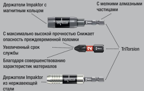
Технология Impaktor обеспечивает срок службы инструментов, заметно превышающий средние показатели даже с учетом жестких условий их применения. Повышенное сопротивление трением за счёт шероховатого покрытия из алмазных частиц предотвращает выскальзывание наколенника из винта. Особенно подходят для работы с предлагаемыми на рынке ударными шурувертами. Шестигранный хвостовик 1/4", подходит для держателя по стандарту DIN ISO 1173-F 6,3.
