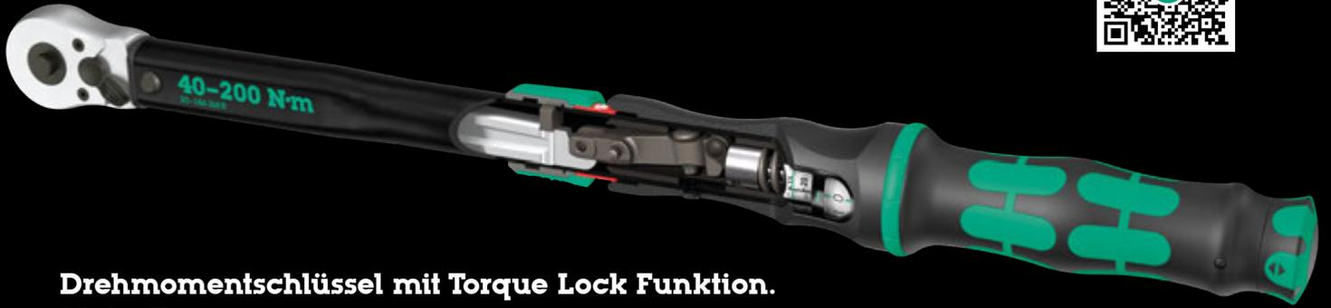
**Drehmomentschlüssel mit Torque Lock Funktion.
