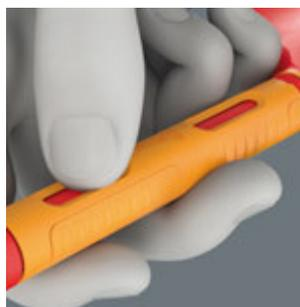
早回しスリーブの凹みにより、指の力で抵抗を発生させることができます。これにより、ネジの抵抗が小さい時でもラチェット機構を使用できます。
